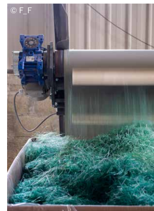
回収した網は裁断・洗浄してからリサイクル工場へ運ぶ。高品質なプラスチック原料とするには、不純物をしっかりと取り除く必要がある。
