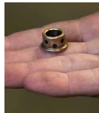
消耗の激しい電動バイクのスタンド部分の部品。ブロンズ製。2個で2€。2年間交換不要。同じ形状でアルミニウム製なら2個で0.30€。
