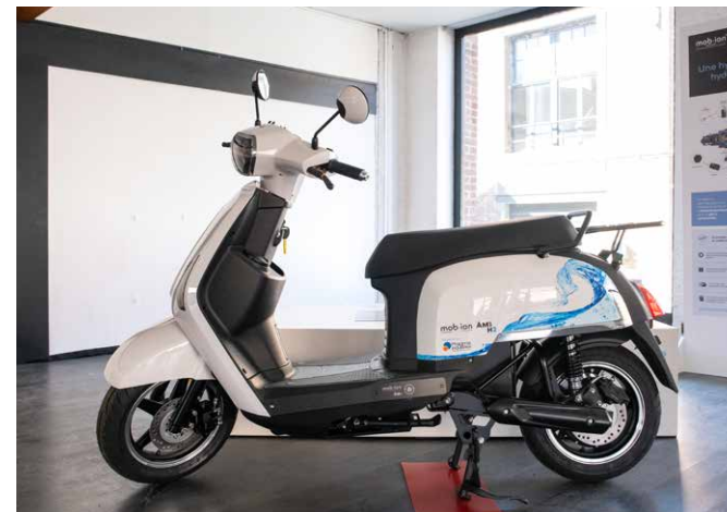
上海のモーターショーでコンセプトカーとして出展した水素貯蔵と燃料電池のハイブリッドタイプ。他社と共同開発を進めている。
